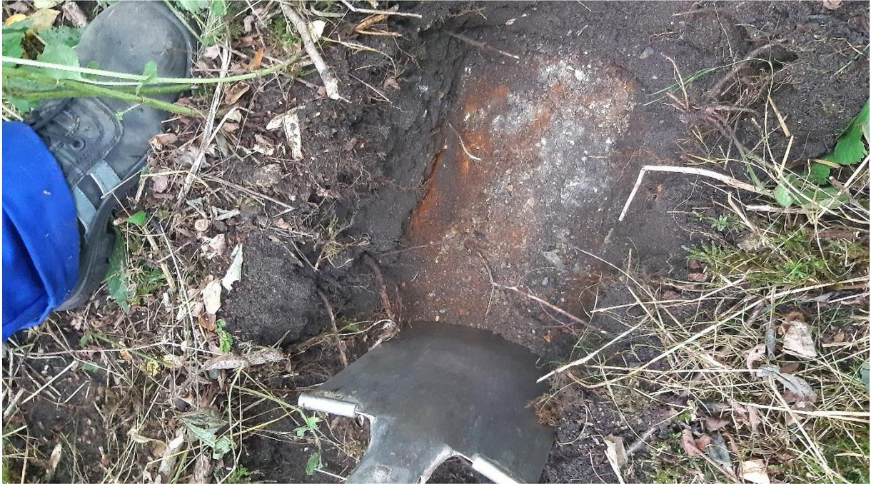
Foto 5: Vermutl. Ziegelreste ab 20 cm, unklare Versiegelung bei D07
