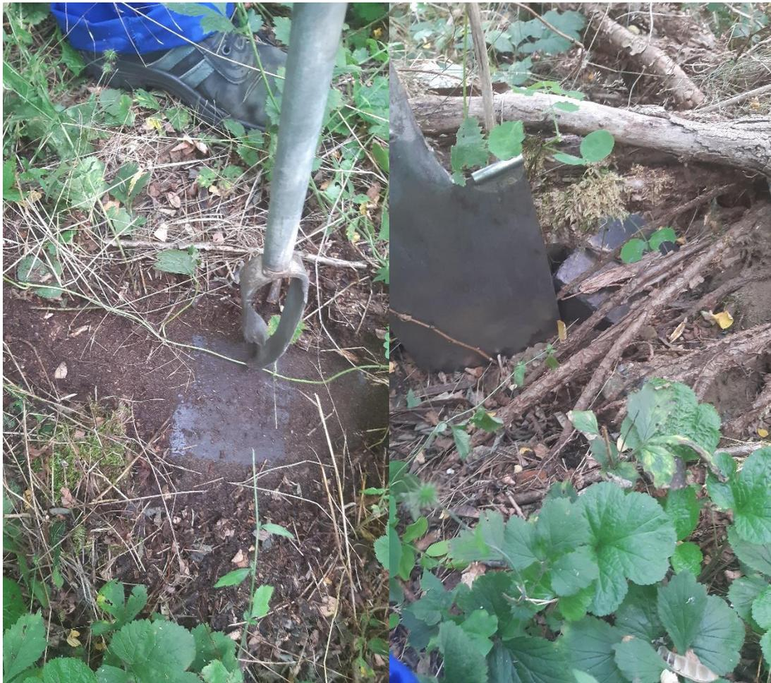
Foto 6: Massive, schwarze Blöcke, unklare Versiegelung bei C10
