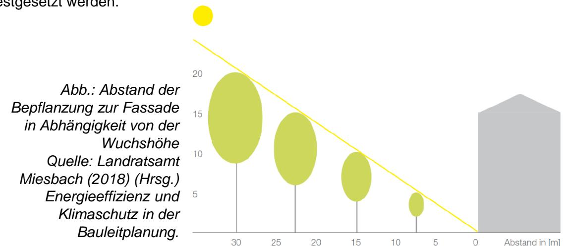
Abb.: Abstand der Bepflanzung zur Fassade in Abhängigkeit von der Wuchshöhe
