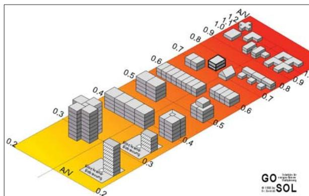
Abb.: Einordnung unterschiedlicher Baukörper hinsichtlich ihres A/V-Verhältnisses
