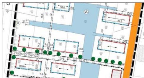
Obiges Beispiel zeigt einen Bebauungsplan, der die Südorientierung durch Festsetzung der Stellung baulicher Anlagen und Firstrichtung sichert und die Verschattungsfreiheit durch Abstimmung der Gebäudehöhen mit den Abständen der Baufenster gewährleistet.
