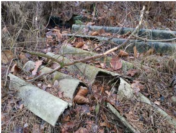
Bild 17: Beispiel von Asbestplattenbruch auf der Vorhabenfläche (20.02.2017)
