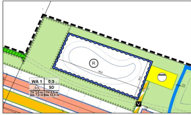
Beispielfestsetzung einer Fläche für die Rückhaltung und Versickerung von Niederschlagswasser (B-Plan Nr. 187 „Soest Nord“ der Stadt Soest) – Die geometrische Form des Beckens ist noch nicht bestimmt. Innerhalb der rechteckigen Fläche soll das Becken eine mögliche Form erhalten. Eine mögliche Gestaltung ist skizzenhaft in der Planzeichnung zur Information dargestellt, aber nicht verbindlich
