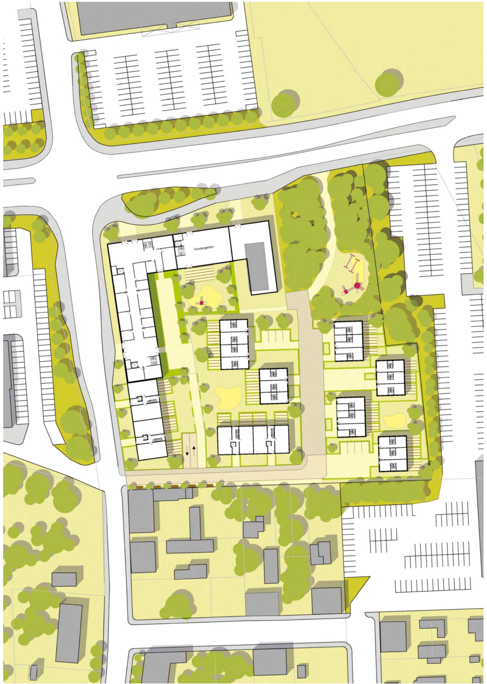
Abb. 17) Variante Townhäuser und Geschosswohnungsbau, Lageplan mit EG-Grundriss, Maßstab im Original Din A3 1 : 500, hier 1 : 1.000 (vorherige Seite)
