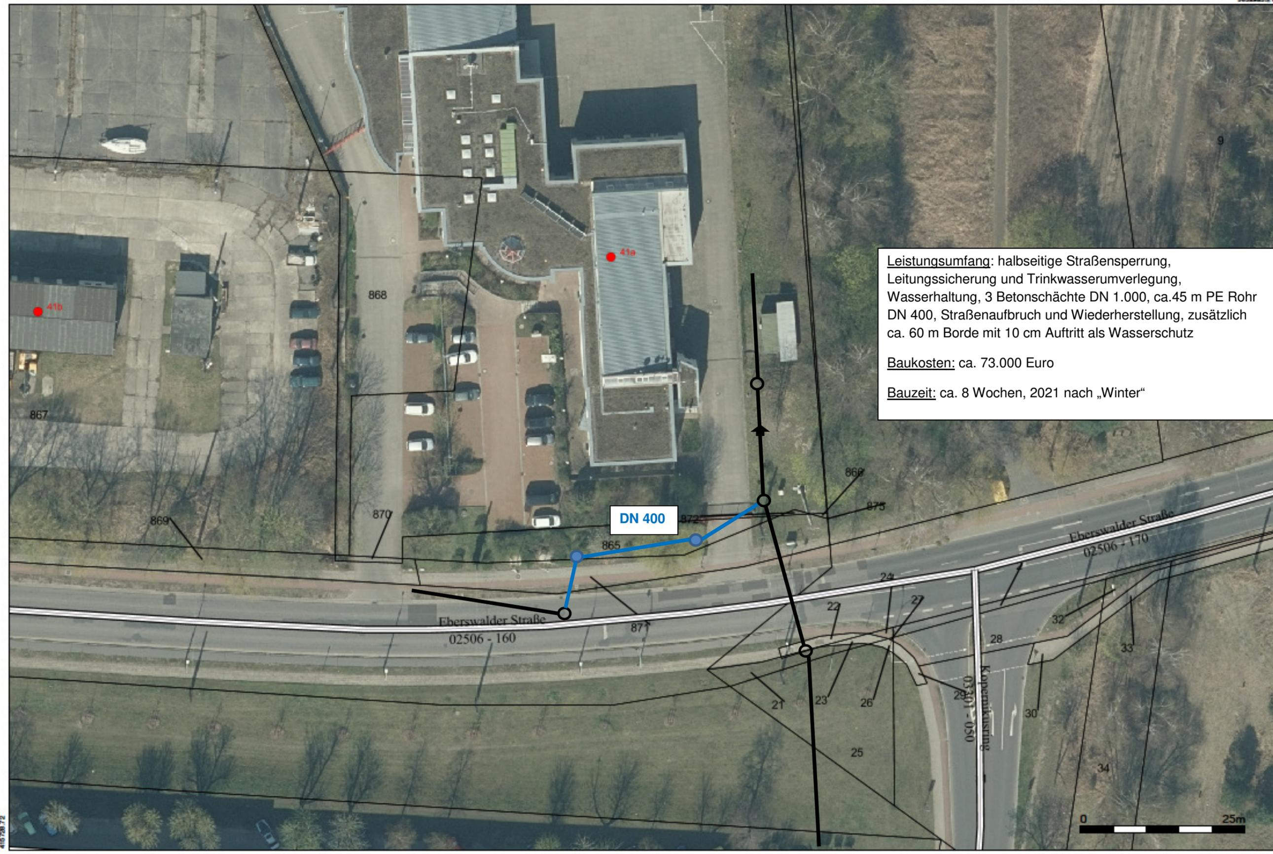
**Leistungsumfang:** halbseitige Straßensperrung, Leitungssicherung und Trinkwasserumverlegung, Wasserhaltung, 3 Betonschächte DN 1.000, ca.45 m PE Rohr DN 400, Straßenaufbruch und Wiederherstellung, zusätzlich ca. 60 m Borde mit 10 cm Auftritt als Wasserschutz
