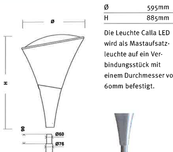
Zylindrischer Mast Ø 60mm
