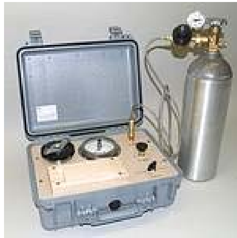
Aufbau und Funktionsweise der Scholander-Bombe
