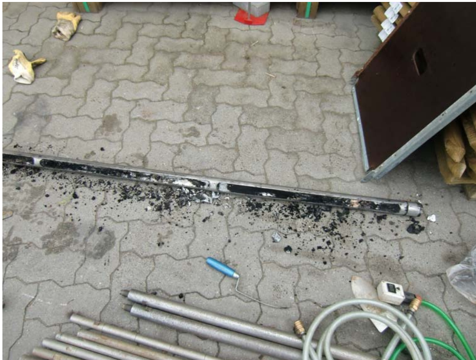
Inhomogene Auffüllungen in BS 1: 1,0 – 3,0 m Teufe
