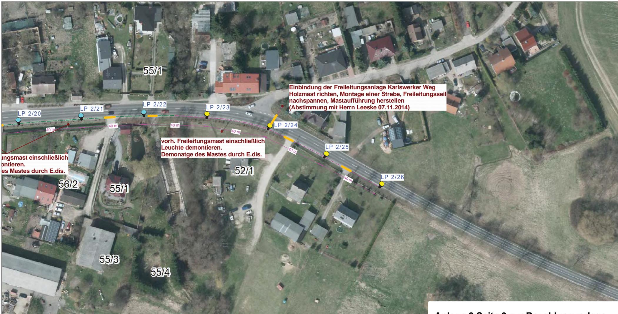
Einbindung der Freileitungsanlage Karlswerker Weg
