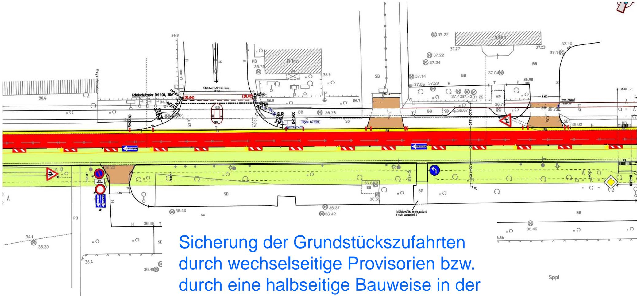
Sicherung der Grundstückszufahrten durch wechselseitige Provisorien bzw. durch eine halbseitige Bauweise in der Zufahrt
