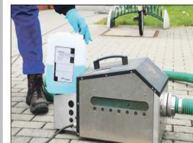
In der Nebelmaschine wird, wie beim sogenannte Disconebel, ein Alkohol-Wasser-Gemisch erhitzt und ist gesundheitlich unbedenklich.
