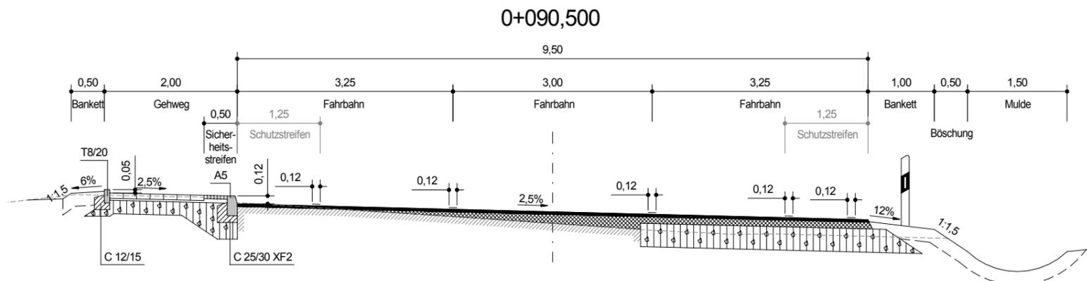
**Fahrbahn Bauklasse IV / F1 (von Stat. 0+046 bis Stat. 0+670 außer KVP)**
