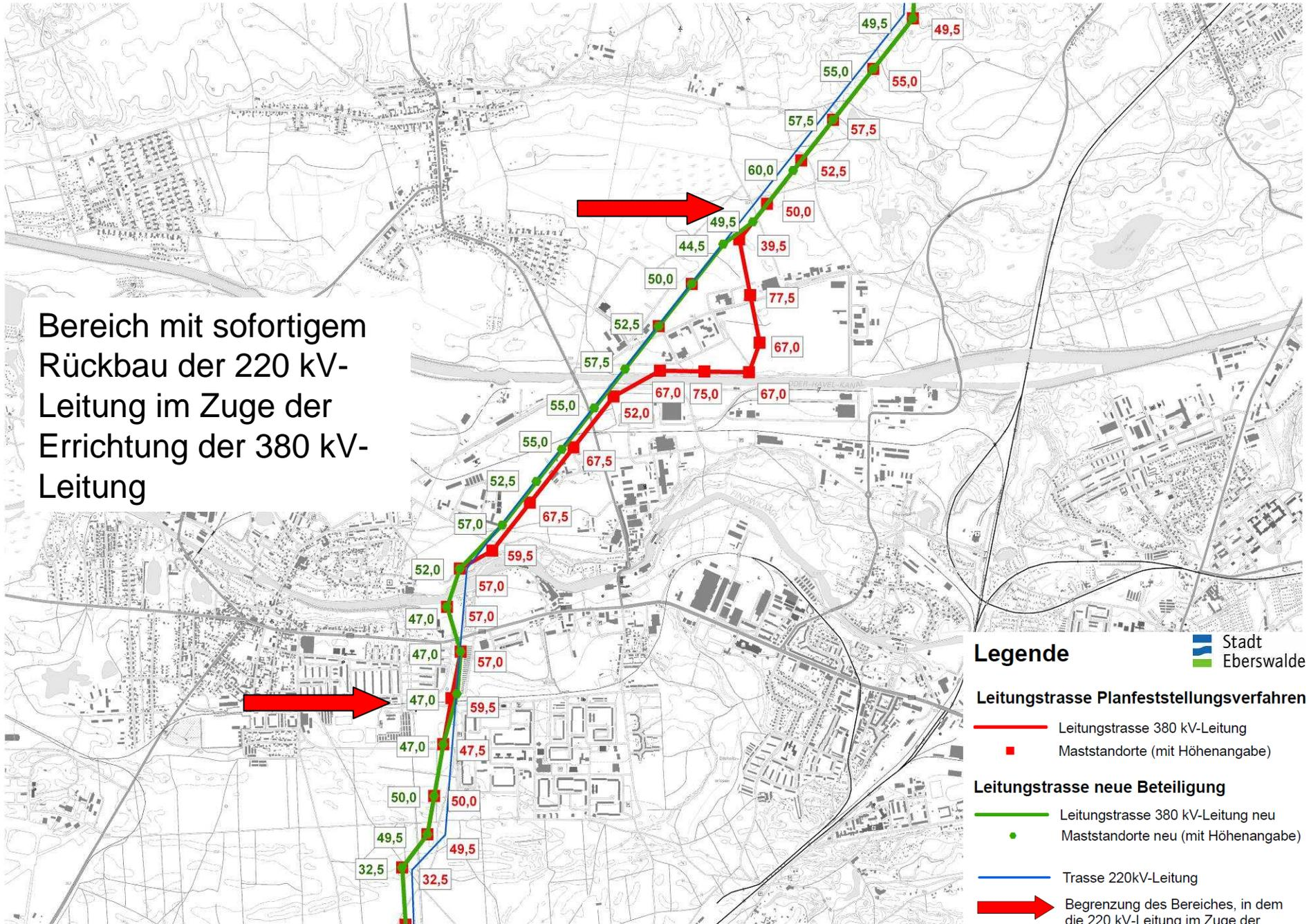
Bereich mit sofortigem Rückbau der 220 kV-Leitung im Zuge der Errichtung der 380 kV-Leitung
