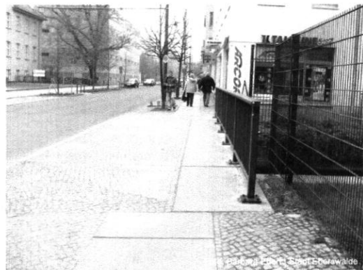
☹ Unterbrechung der Gehbahnmarkierung - fehlende Mobilitätskette
